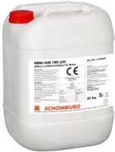
REMI-AIR/LP یک حباب ساز بتن است که برای تمام بتن‌های کلاس XF1 تا XF4 بر اساس آیین نامه EN 206 در شرایط یخ‌بندان و قرارگیری در معرض سیکل یخ / ذوب و نمک‌های یخ‌زدایی مناسب می‌باشد. از جمله مزایای این افزودنی می‌توان به ایجاد حباب‌های ریز هوا تا ۲۰۰ میکرون، پخش یکنواخت حباب‌ها در ماتریس، کاربری، پیوستگی و قابلیت پمپاژ بهتر، عدم تأثیر منفی بر هیدراسیون سیمان و افزایش دوام در محیط‌های سرد و سیکل‌های یخ و ذوب به دلیل کاهش پوسته پوسته شدن سطح اشاره کرد.
