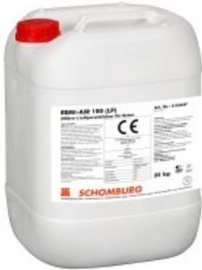
REMI-AIR/LP یک حباب ساز بتن است که برای تمام بتن‌های کلاس XF1 تا XF4 بر اساس آیین نامه EN 206 در شرایط یخ‌بندان و قرارگیری در معرض سیکل یخ / ذوب و نمک‌های یخ زدایی مناسب می‌باشد. از جمله مزایای این افزودنی می‌توان به ایجاد حباب‌های ریز هوا تا ۲۰۰ میکرون، پخش یکنواخت حباب‌ها در ماتریس، کاربری، پیوستگی و قابلیت پمپاژ بهتر، عدم تأثیر منفی بر هیدراسیون سیمان و افزایش دوام در محیط‌های سرد و سیکل‌های یخ و ذوب به دلیل کاهش پوسته پوسته شدن سطح اشاره کرد.
